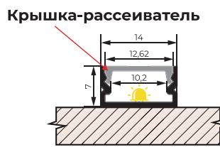
Универсальный П-образный профиль наклеивается (прикручивается) на ровные поверхности: крышку, дно, стойки. Видимая высота профиля над плоскостью корпуса - **7 мм**.
