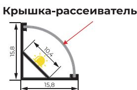
Монтаж угловой алюминиевой основы производится в место стыка дна/крышки и стенки (боковой, задней) на саморезы. Форма квадранта ( $1/4$  круга) позволяет добиться равномерного освещения.
